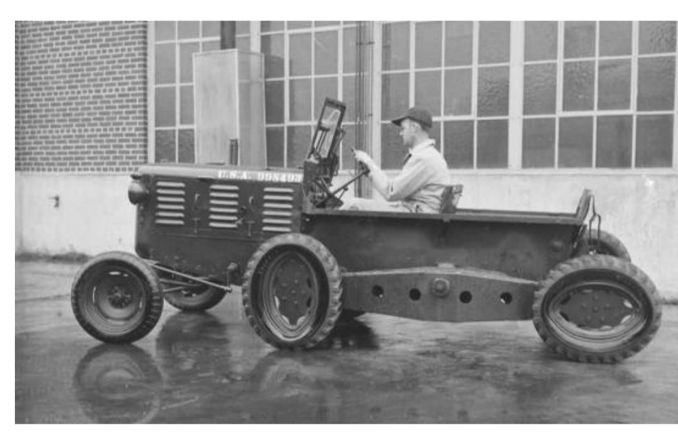
Tracteur M7 muni de roues elliptiques calées à 90° pour éviter le patinage (1946)
