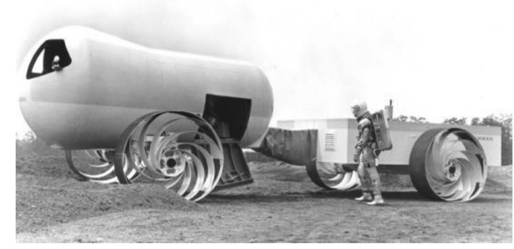
Roue à ressorts en spirale 1964, Le Grumman Molab
