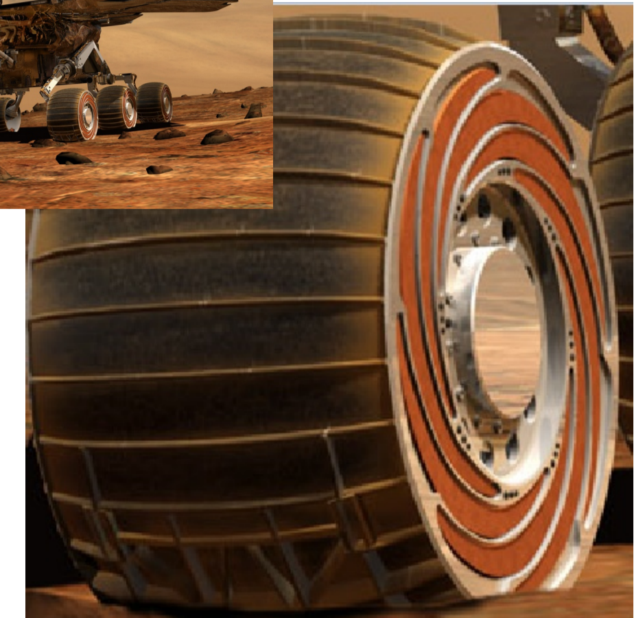
Roue à ressorts en spirale utilisée en 2004 par la NASA sur les rovers jumeaux Spirit et Opportunity
