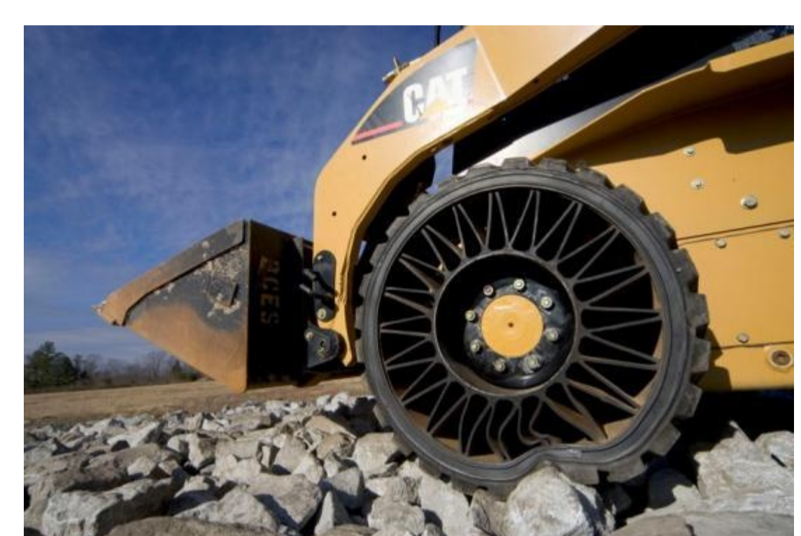
Roue Tweel de Michelin 2006, retenue par la NASA pour les futurs rovers lunaires
