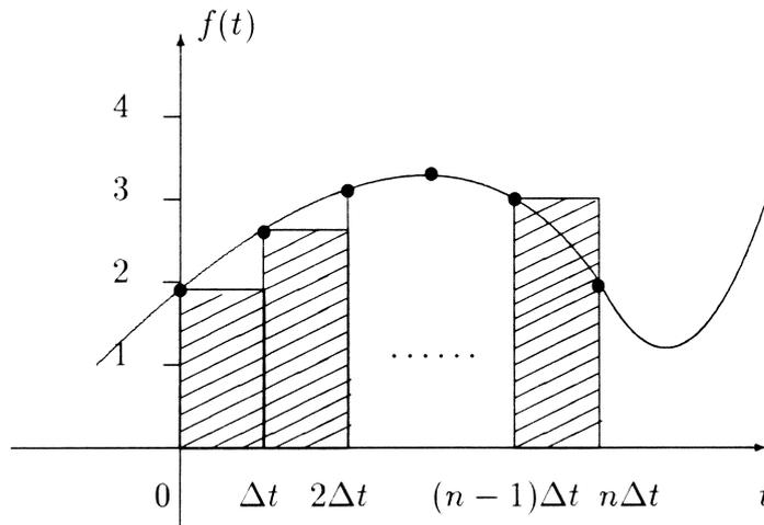
on est conduit à approcher l'intégrale  $\int_0^{n\Delta t} f(u) du$  par :
