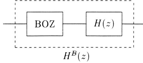
C'est la fonction de transfert bloquée en  $z$ ,  $H^B(z)$ , qu'on doit déterminer. Or, la fonction de transfert bloquée en  $p$ ,  $H^B(p)$ , est le produit de la fonction de transfert en  $p$ ,  $H_B(p)$ , du BOZ par la fonction de transfert en  $p$ ,  $H(p)$  du système non bloqué.
