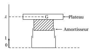
L'étude de ce système mécanique permet de considérer que la fonction z est solution de l'équation différentielle
