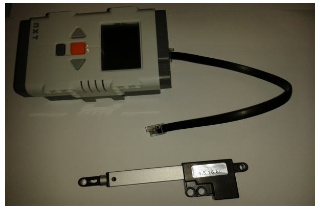
Illustration 5.6: En bas, un vérin piloté L12-nxt de la marque Firgelli. En haut, la brique programmable NXT qui commande le vérin à travers un câble électrique.
