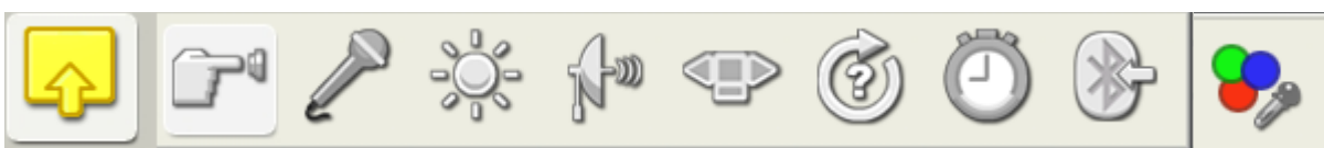
Illustration 6.9: Bouton de capteurs: Capteur tactile, capteur sonore, capteur de lumière, capteur ultrasons, boutons de la brique, capteur d'angle de rotation, minuteur, récepteur de message, capteur de couleur.
