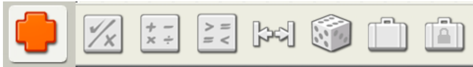
Illustration 6.11: Bouton de données mathématiques: Opérations de logique, opérations de calculs, comparaison de données, définir une plage de données, données aléatoires, bloc de variables, bloc déclaration de constantes
