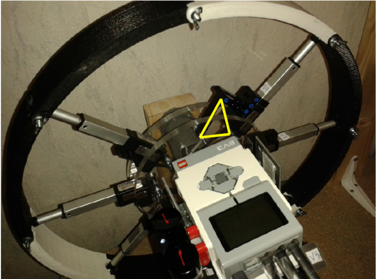
Illustration 5.32: Patte ajoutée pour bloquer le 1er vérin en position perpendiculaire à la jante et empêcher ainsi le moyeu de tourner sur lui même.
