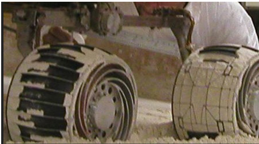
Illustration 5.4: Photo qui montre la recherche par des spécialistes d'une solution du problème d'enlisement dans les sables du robot Spirit (Source Nasa [2]). Recherche faite sur une copie de Spirit restée sur terre.
