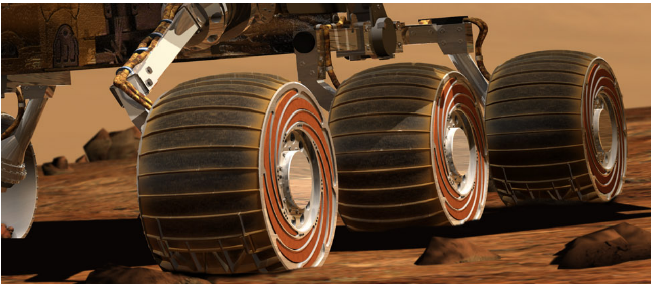
Illustration 5.2: Côté extérieur des roues du rover Spirit et leur ressort en spirale.
