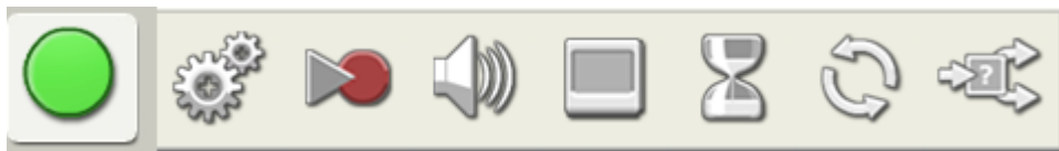
Illustration 6.7: Bouton commun contenant: bloc de commandes pour moteurs, enregistrement et restitution, bloc son, bloc affichage, bloc de temporisation, bloc boucle et bloc de commutation(silors)
