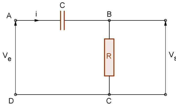
On pourra faire un premier TP qui mettra en évidence les notions de « fréquence de coupure » et de « gain en tension ».
