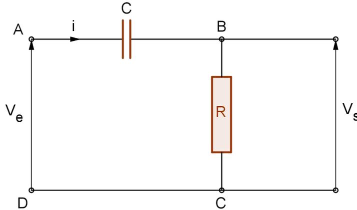
On admet que les tensions  $V_e$  (tension d'entrée exprimée en volts) et  $V_s$  (tension de sortie exprimée en volts) sont des tensions sinusoïdales de même pulsation  $\omega$  définies en fonction du temps  $t$ , exprimé en secondes.
