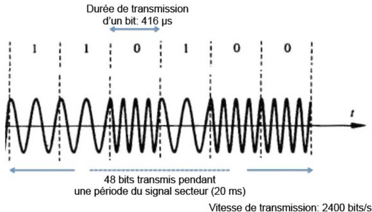
Durée de transmission d'un bit : 416  $\mu\text{s}$
