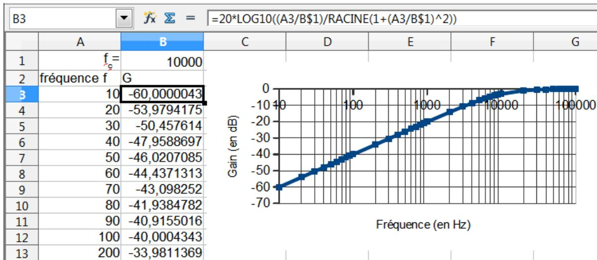
Pour mettre en évidence la notion de filtre, on peut faire un deuxième TP avec la résolution d'une équation :  $u + RCu' = Ve(t)$  où  $Ve(t)$  est la tension d'entrée. On aura  $Vs = Ve - u$  en sortie et on pourra remarquer que le signal n'est presque pas modifié avec un signal de fréquence 74 kHz ou 63.3 kHz, mais qu'il devient du même ordre avec un signal de 50 Hz.
